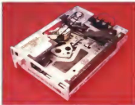
Una veduta della meccanica con la testina in posizione operativa e, a destra, il posizionamento errato agente sul nastro presso il frontale.
